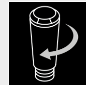
Wkręcanie filtra do zbiornika wody
