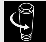
Wykręcanie filtra ze zbiornika wody
